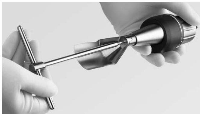
Vérifier que la lame de scie est correctement insérée et serrée.
